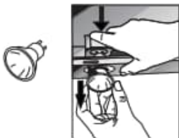
Fig. 26: Fig 25: Udskiftning af GU10 Lyskilde
